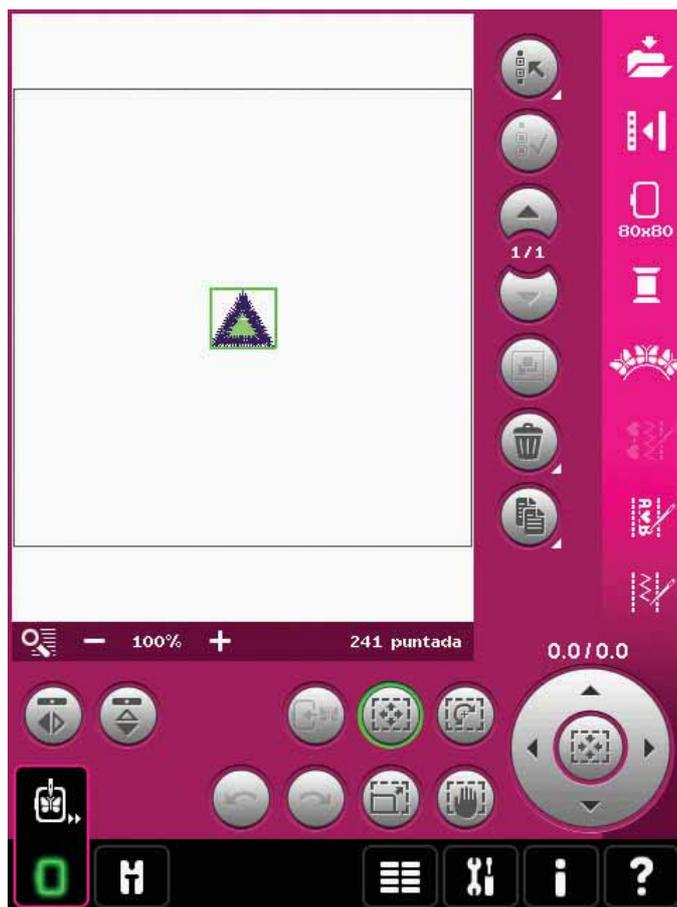
2. Abra la función Shape Creator™ básica. Seleccione el círculo en sentido de las agujas del reloj en la lista (A). Pulse Introducir número de diseños (B) para abrir el teclado, escriba 18 y pulse Aceptar.
