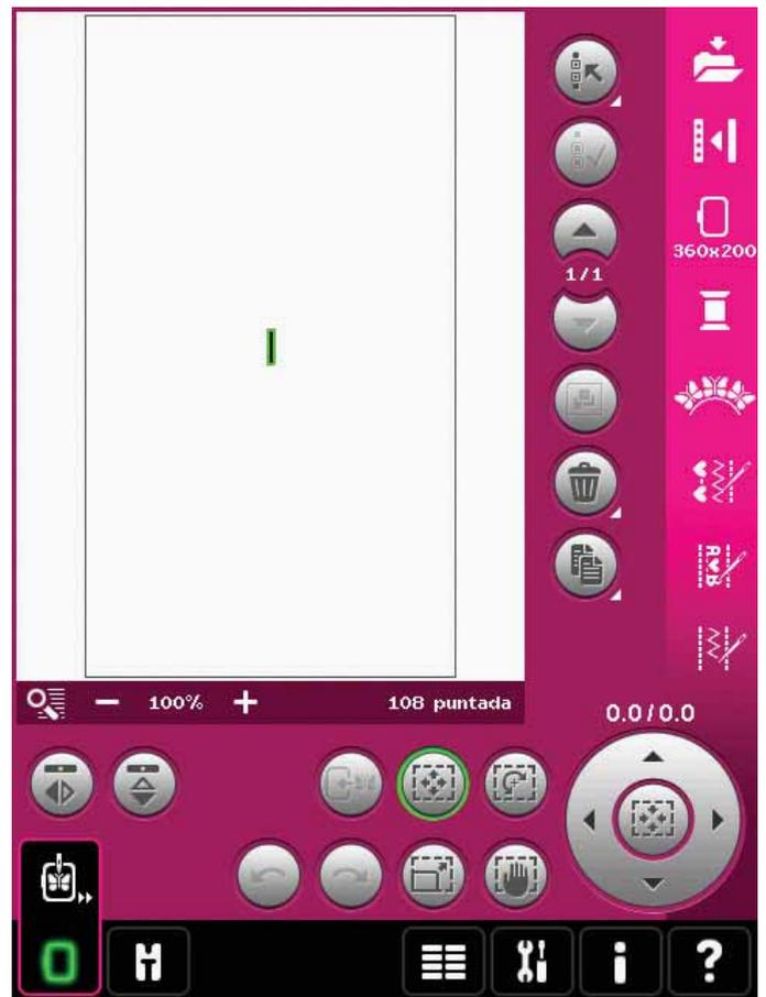
2. Abra la función Shape Creator™ básica. Seleccione la línea recta de la lista (A). Pulse la tecla de función - Girar y después pulse el centro de la rueda una vez para girar la línea de base 90 grados.
