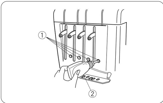
Aplique unas gotas de aceite a la barra de agujas por los orificios de la cubierta delantera.
