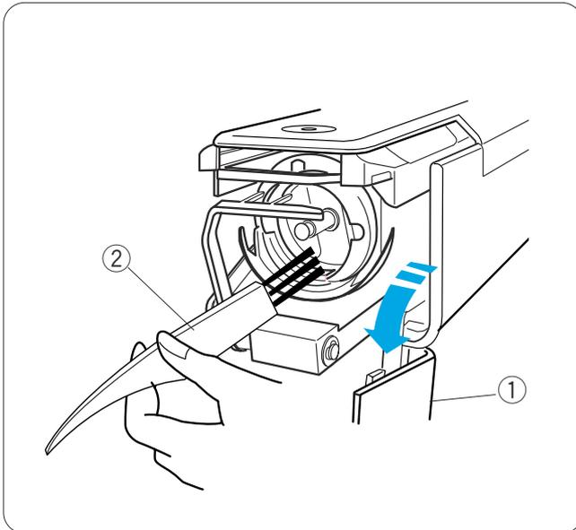
Abra la cubierta del portabobinas y saque la caja de la bobina.
