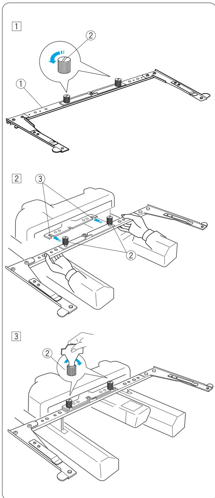
1 Afloje los dos tornillos de palomilla situados sobre el soporte del bastidor.
