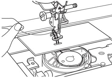
→ Del orificio en la placa de la aguja saldrá un lazo del hilo de la bobina.
