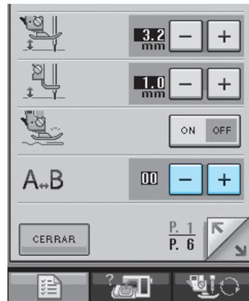
La gama de ajustes oscila entre "00" y "10". El ajuste por defecto es "00". Cada ajuste equivale a una distancia específica entre caracteres.
