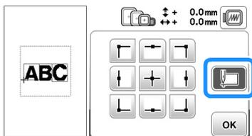
→ La aguja se coloca en la esquina inferior izquierda del patrón. El bastidor de bordado se mueve para que la aguja se coloque correctamente.
