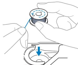
Si la bobina se inserta con el hilo desenrollándose en la dirección incorrecta, la costura se realizará con una tensión del hilo incorrecta.
