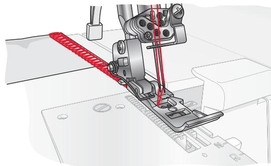
*Consejo: Cuando haya reenhebrado la máquina, realice siempre una cadeneta exenta (sin tela) y cose una muestra para comprobar la tensión del hilo.*
