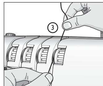
5. Enhebre la zona de la devanadora de la máquina siguiendo las guías de los hilos codificados de color azul (4-8). Use las pinzas para facilitar el enhebrado.
