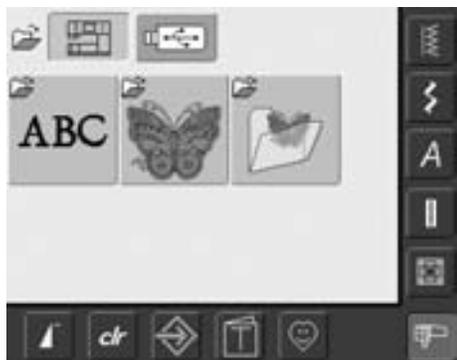
El menú de selección aparece después de conectar la máquina de bordar computerizada o después de conmutar de modo costura a modo bordado, también al seleccionar una muestra de bordado o al combinar con una muestra de bordado ya existente.
