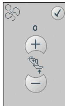
*Menú emergente para seleccionar la altura del prensatelas en MovLibre Sensormatic.*
